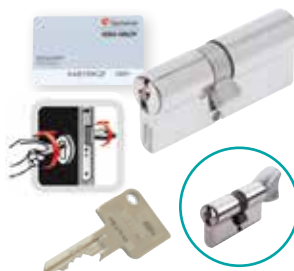
BARILLET VMI+ avec fonction clé de secours, très résistant au crochetage, 5 goupilles en acier trempé. Clé de forte section (3 mm) à perçage latéral, offrant une bonne prise en main, barillet fourni avec carte de propriété – 4 clés Option : barillet bouton moleté VMI+ - 4 clés
